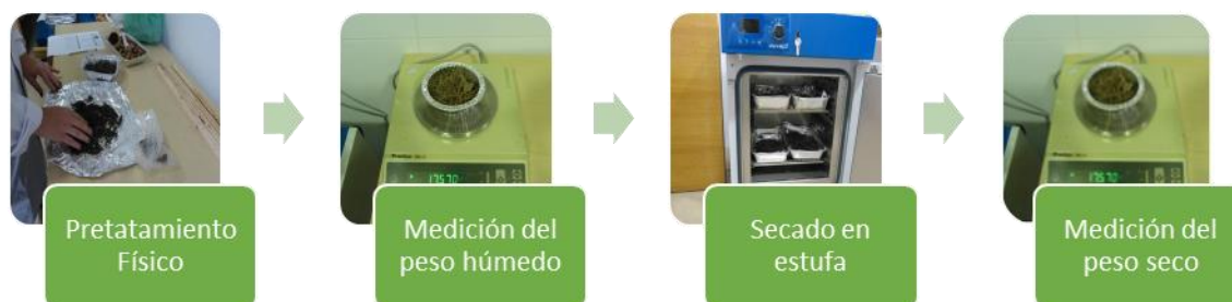
Figura 11. Procedimiento de tratamiento de las muestras obtenidas en campo
